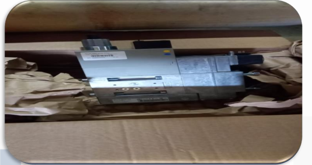
Isıtma sistemi arızalı valfi değiştirilmiştir.
