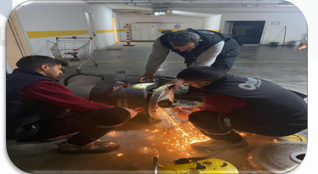
Zemin temizleme otomatı tekerlek arızası giderilmiştir.
